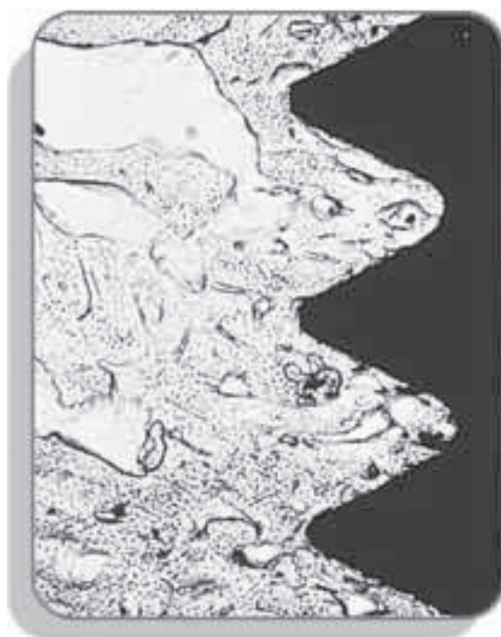
Bildo 4. Mikroskopa foto de metala ŝraŭbo ligata al vivanta ostoj
